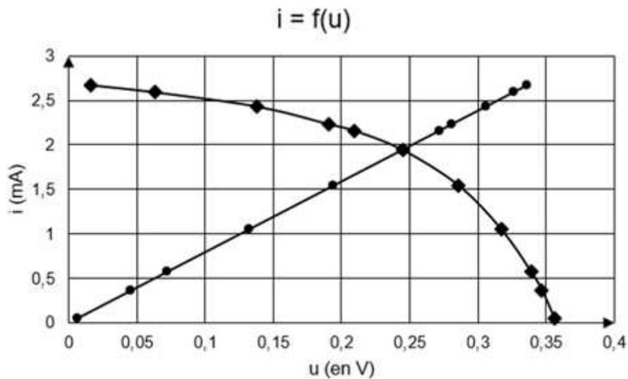
**5-** À l'aide des caractéristiques  $i=f(u)$  de la résistance et du capteur photovoltaïque données dans le document 3, déterminer les coordonnées  $(u ; i)$  du point de fonctionnement du circuit puis calculer la valeur de la résistance permettant de maximiser la puissance délivrée par le capteur photovoltaïque. Le résultat est-il cohérent avec celui trouvé à la question 4 ?
