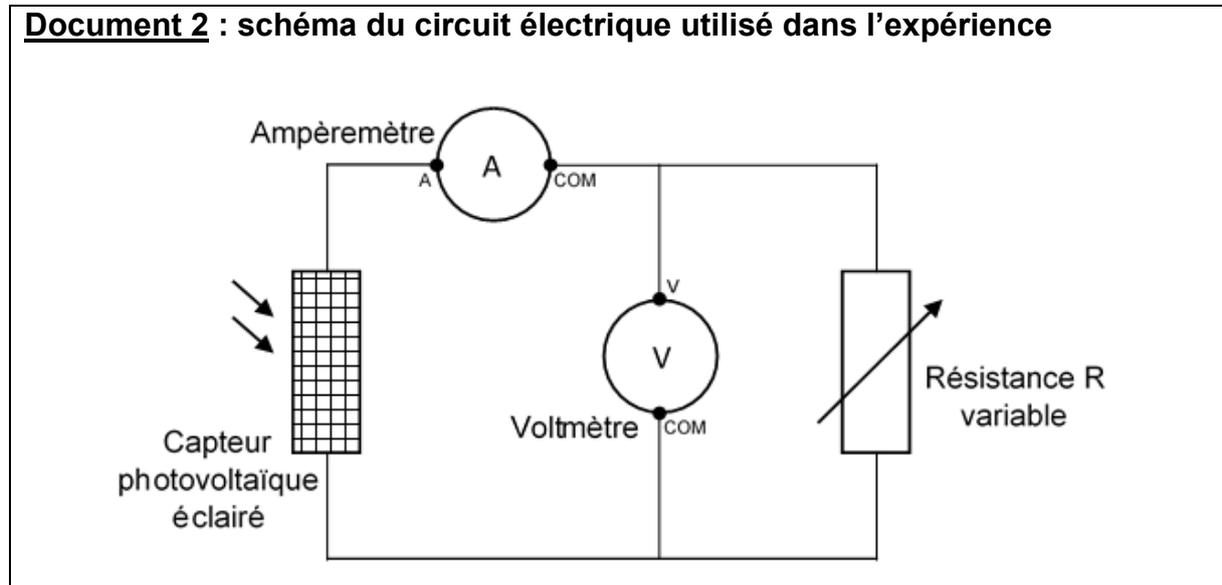
4- Compléter sur le document de l'annexe, le tableau représentant les résultats des mesures en calculant la puissance pour chaque couple de valeurs (u ; i) puis déterminer la valeur de la résistance permettant de maximiser la puissance délivrée par le capteur photovoltaïque.
