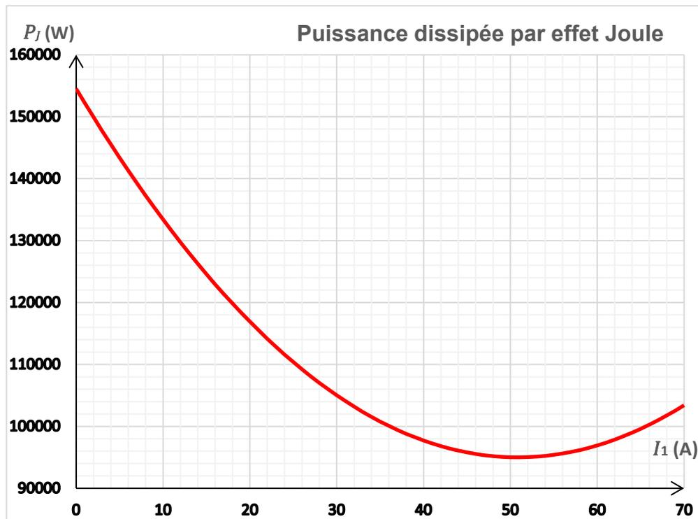
8- La contrainte sur les intensités délivrées par les sources impose que  $I_1$  peut prendre une valeur comprise dans l'intervalle  $[0 ; 70]$ .
