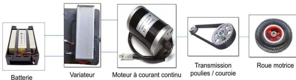
Figure 3 : Chaîne de puissance du skateboard
