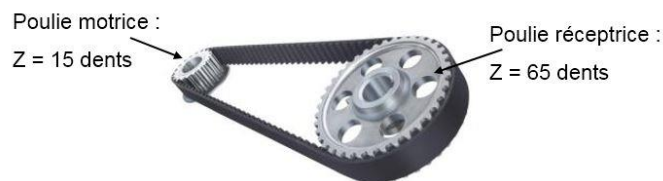
Figure 4 : Caractéristiques du système poulies / courroie
