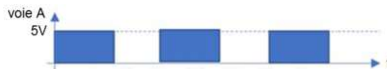
Figure 9 : signal en créneau délivré par le capteur lors de la rotation de la roue
