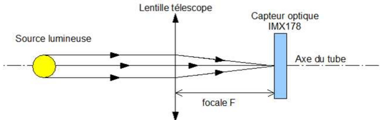
Figure 2 : Pointage correct d'un astre
