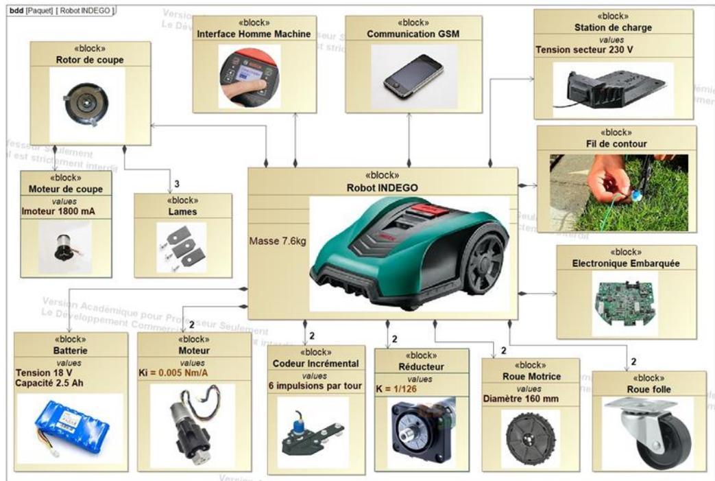
Figure 1.4 : Diagramme des définitions de blocs
