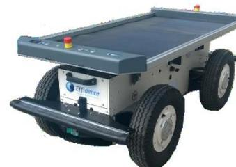
Effibot est en permanence protégé par un système anticollision, fonctionnant à 360° autour du véhicule, qui lui permet d'éviter et de contourner automatiquement tout obstacle qu'il aura détecté dans son environnement.
