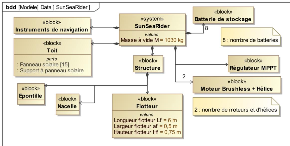
Figure 2 : diagramme partiel de définition des blocs
