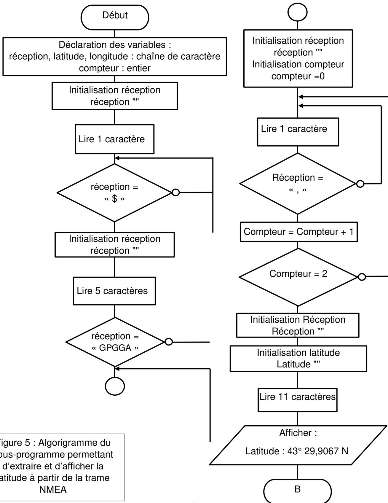
Figure 5 : Algorithme du sous-programme permettant d'extraire et d'afficher la latitude à partir de la trame NMEA
