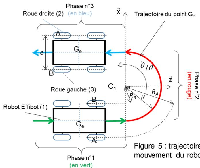
Figure 5 : trajectoire et mouvement du robot Effibot (1)
