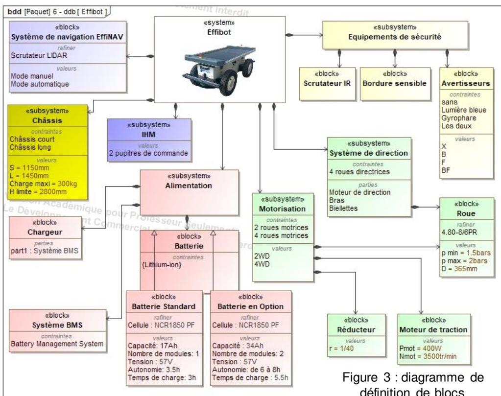
Figure 3 : diagramme de définition de blocs
