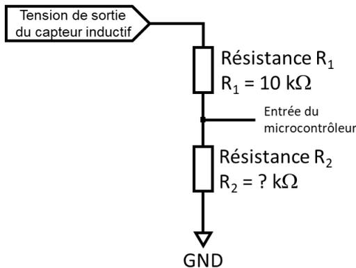
En sortie d'un capteur inductif, il est nécessaire d'adapter la tension délivrée pour être conforme aux caractéristiques des entrées numériques du microcontrôleur.
