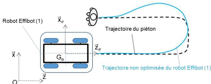
Figure 4 : schéma du robot Effibot (1)
