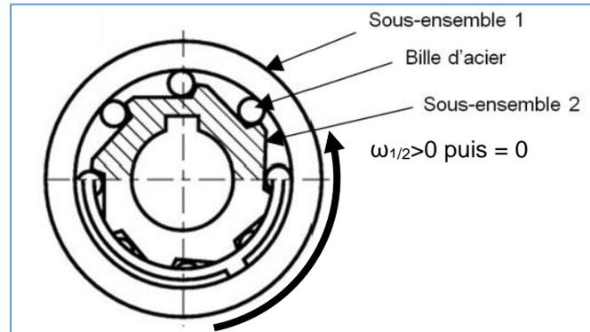
Les aimants liés au sous ensemble 1 deviennent donc immobiles par rapport à la fourche du vélo, ce qui provoque la rotation de la roue électrique. Lorsque l'assistance est désactivée, ou que le vélo va à une vitesse supérieure à 25 km·h<sup>-1</sup>, les bobines et les aimants sont magnétiquement liés, donc le sous-ensemble 1 tourne dans le sens anti-trigonométrique (horaire) par rapport au sous-ensemble 2 ce qui a pour effet de libérer les billes de la roue libre.
