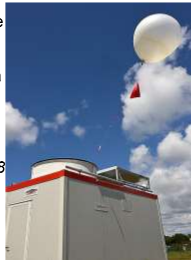
Figure 1 : lâcher de ballon automatique © Météo-France, Pascal Taburet
