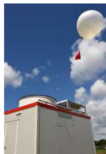
Figure 1 : lâcher de ballon automatique © Météo-France, Pascal Taburet
