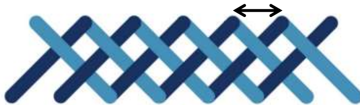
Figure 2 : Croisillon vu de dessus : le croisillon est caractérisé par le pas noté p , distance entre deux sommets consécutifs sur un des bords du croisillon
