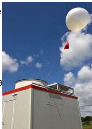
Figure 1 : lâcher de ballon automatique © Météo-France, Pascal Taburet
