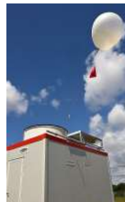
Figure 1 : lâcher de ballon automatique © Météo-France, Pascal Taburet
