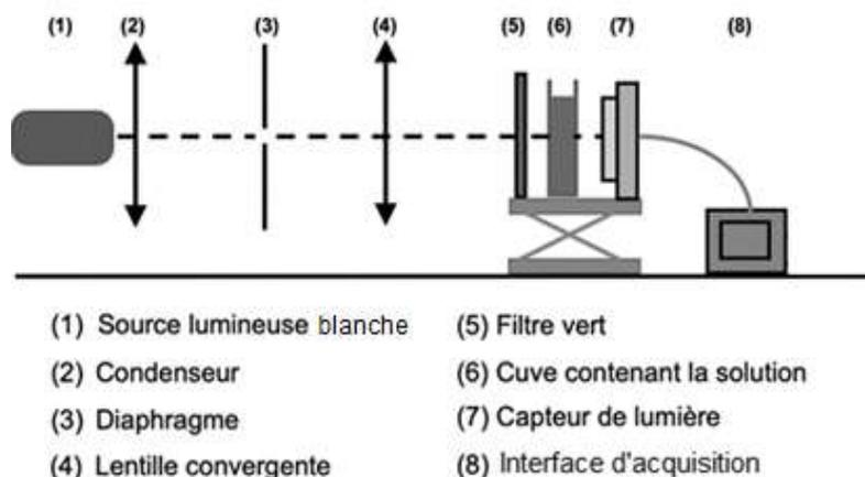
La lentille (4) permet de fabriquer un faisceau de lumière parallèle ; le constructeur indique, pour cette lentille, une valeur de distance focale de 5,0 cm.
