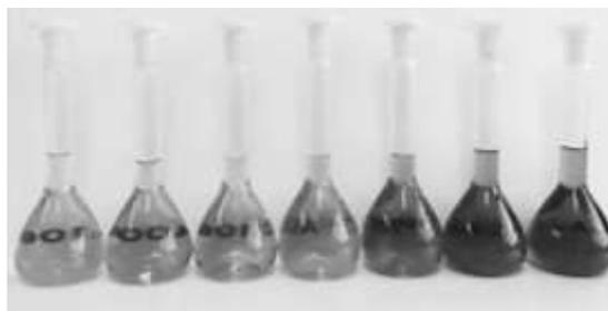
Un traitement des données expérimentales acquises par l'interface d'acquisition, permet à la technicienne d'obtenir la valeur de l'absorbance  $A$  de chaque solution étalon. Elle trace le graphe représentant l'évolution de l'absorbance  $A$  en fonction de la concentration  $C$  de la solution en permanganate de potassium. Le graphique est donné en annexe. Indiquer si avec la gamme étalon utilisée, la relation de Beer-Lambert peut s'appliquer.
