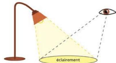
Un lux est l'éclairement d'une surface qui reçoit, d'une manière uniformément répartie, un flux lumineux d'un lumen par mètre carré.
