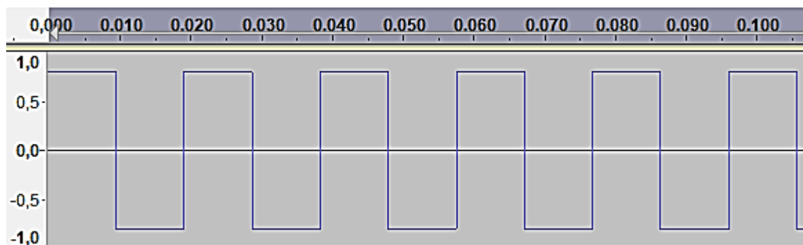
Figure 2 : Signal sonore 2 : en abscisse, au-dessus du graphe, le temps exprim  en secondes ; en ordonn e, la tension  lectrique proportionnelle   l'intensit  sonore du signal.
