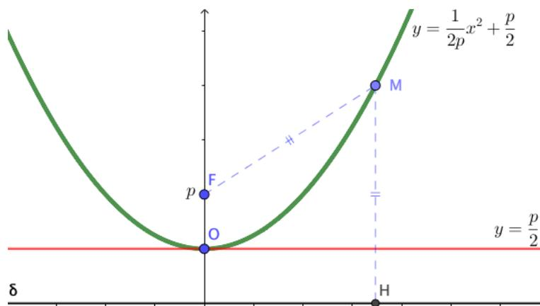
Dans le repère considéré, l'axe des abscisses est la directrice de la parabole, l'axe des ordonnées son axe, le foyer a pour coordonnées  $(0, p)$  et l'équation de la parabole est  $y = \frac{1}{2p}x^2 + \frac{p}{2}$ .
