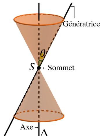
En reprenant les notations précédentes, une parabole  $\mathcal{P}$  est la courbe obtenue par l'intersection d'un cône et d'un plan  $\Pi$  parallèle à l'une des génératrices du cône.
