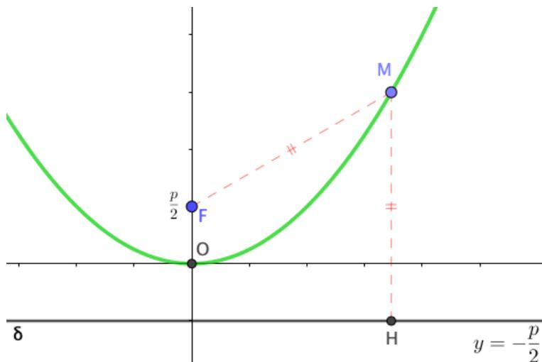
Dans le repère considéré, l'axe des abscisses est la tangente de la parabole en son sommet (point d'intersection avec l'axe), l'axe des ordonnées est son axe, le foyer a pour coordonnées  $\left(0, \frac{p}{2}\right)$  et l'équation de la parabole est  $y = \frac{1}{2p}x^2$ .
