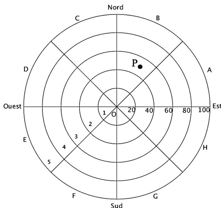
Le capteur de foudre étant représenté par le centre de l'écran, cinq cercles concentriques correspondant aux rayons respectifs 20, 40, 60, 80 et 100 kilomètres délimitent dans l'ordre cinq zones, numérotées de 1 à 5, définies par leur distance au capteur. De plus, huit segments partant du capteur délimitent huit portions, de même ouverture angulaire, nommées dans le sens trigonométrique de A à H.
