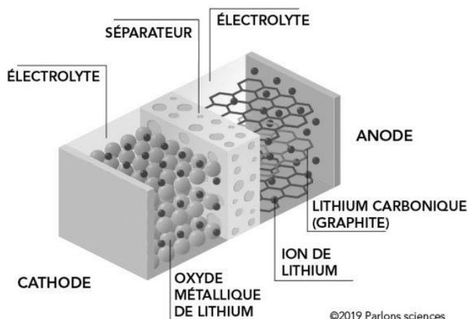
Figure 1 : Schéma d'une pile lithium-ion
