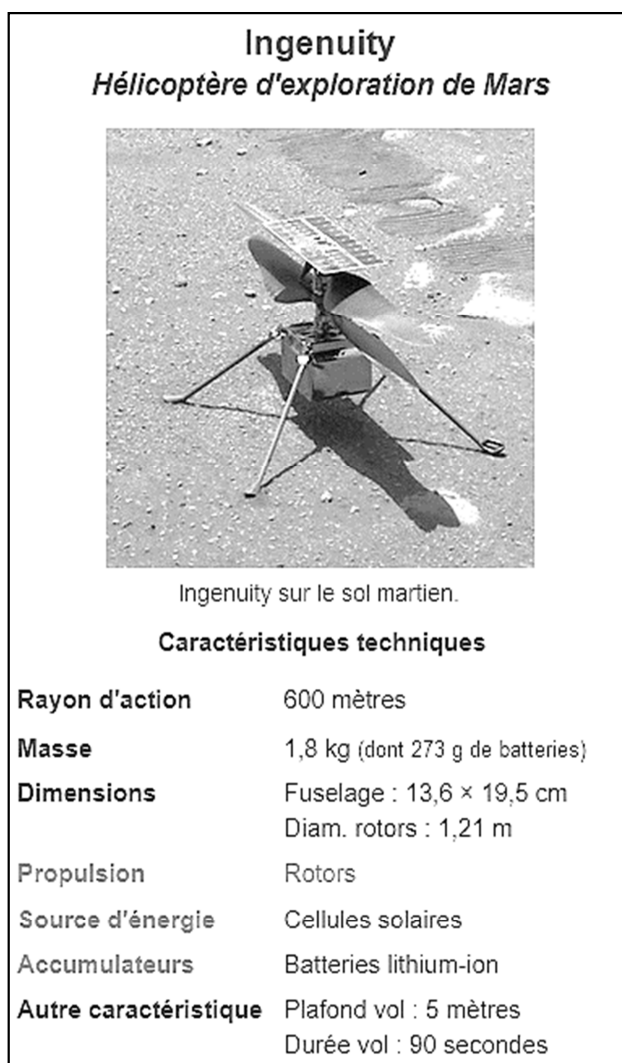
Figure 1 : Caractéristiques techniques d'Ingenuity
