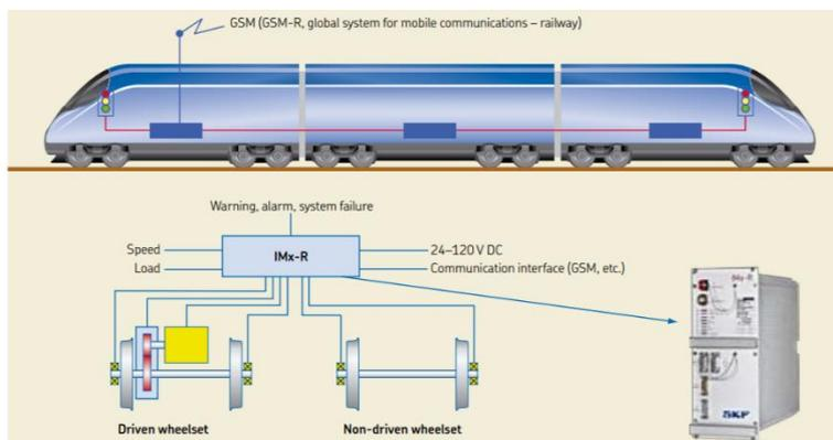
Figure I-1 : Synoptique de la chaîne d'information
