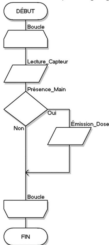
Figure 7 : Algorithme de fonctionnement du distributeur de savon
