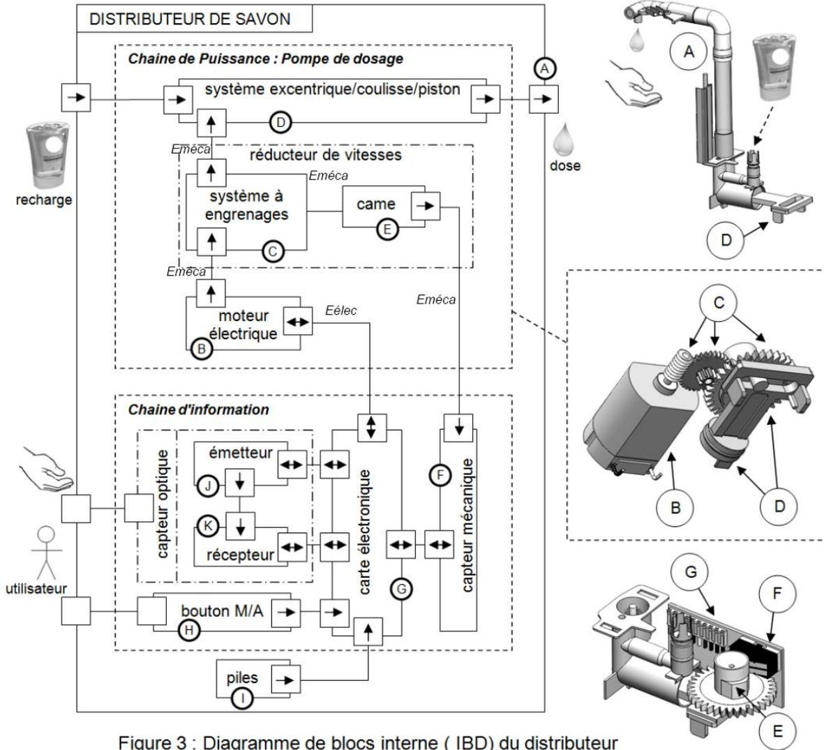
Figure 3 : Diagramme de blocs interne ( IBD) du distributeur
