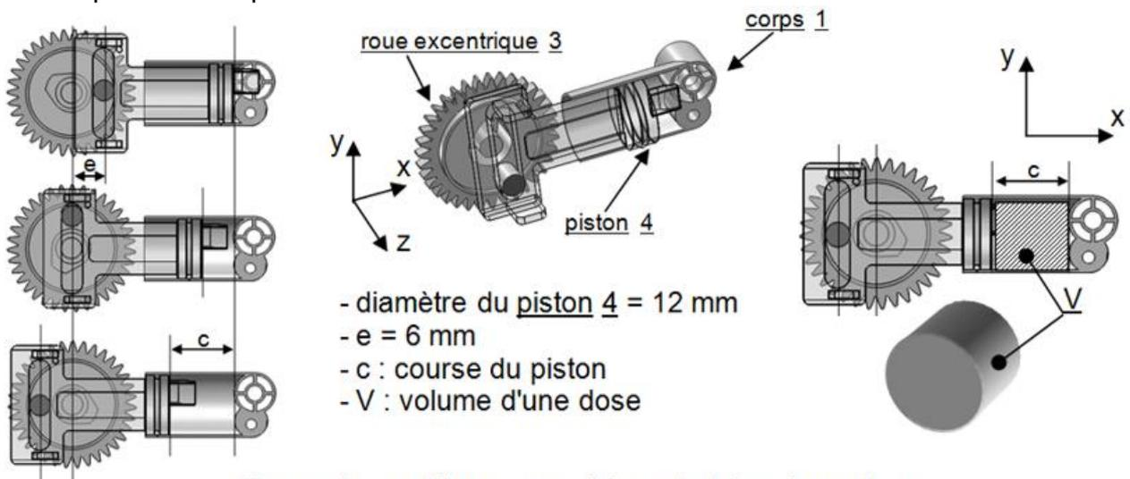
Figure 4 : système excentrique / piston à coulisse
