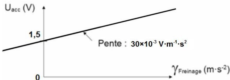
Figure 7 : Caractéristique  $U_{\text{acc}} = f(\gamma_{\text{Freinage}})$  de l'accéléromètre
