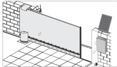
L'ouverture du portail peut être complète pour permettre l'accès à une voiture ou partielle pour un piéton ou un cycliste. Pendant la phase d'ouverture, si un obstacle est détecté le portail s'immobilise pour garantir la sécurité des personnes et des biens. L'ouverture du portail est déclenché à distance à l'aide de commandes pouvant prendre différentes formes (smartphone, clavier à code, visiophone ou télécommande).
