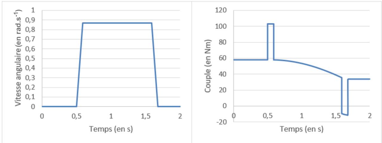
Figure 1-4 : loi de mouvement en trapèze de vitesse et couple de l'actionneur 2
