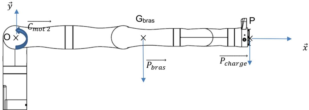
Figure 1-3 : étude statique bras robotisé en position horizontale
