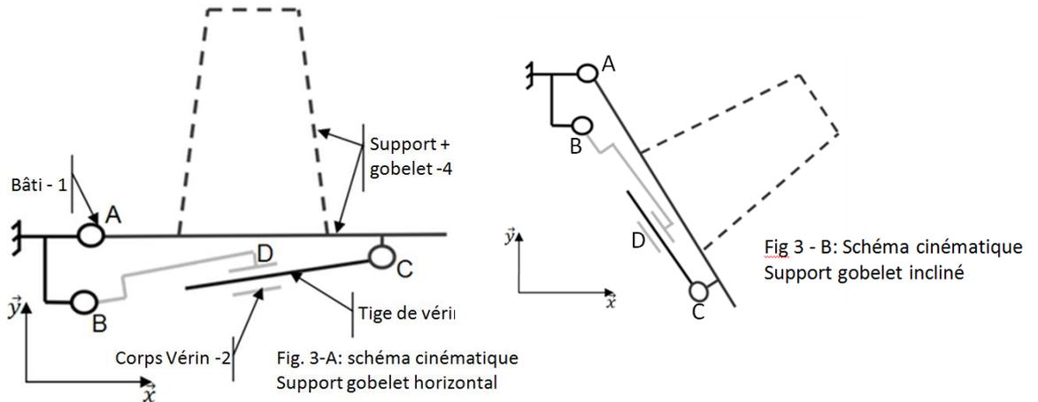
Le schéma cinématique retenu par les concepteurs du système pour transférer un gobelet vers la zone de stockage est représenté sur la figure 3.
