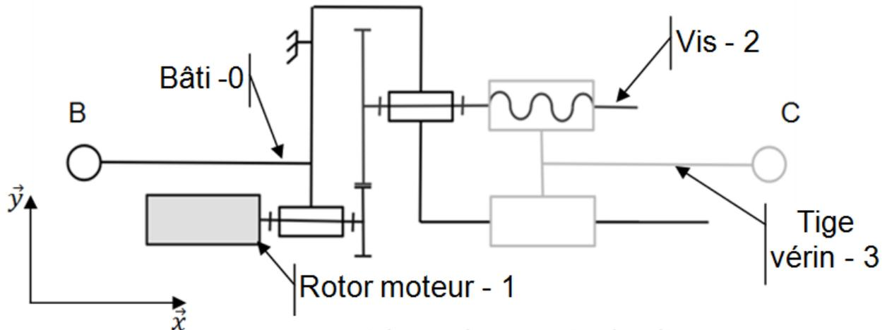
Figure 5 : Schéma cinématique du vérin électrique
