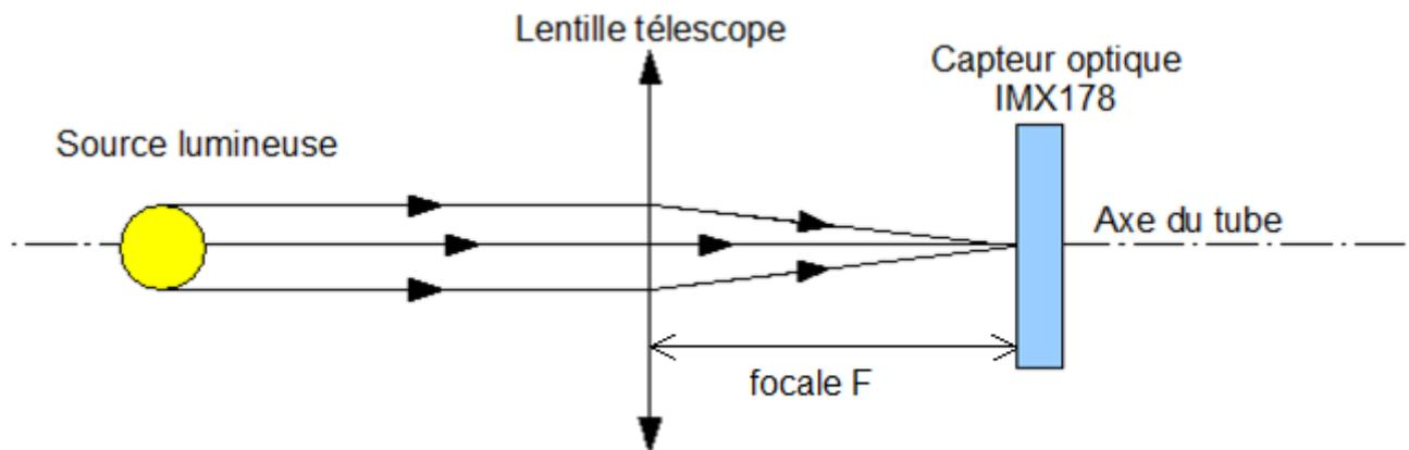
Figure 2 : Pointage correct d'un astre
