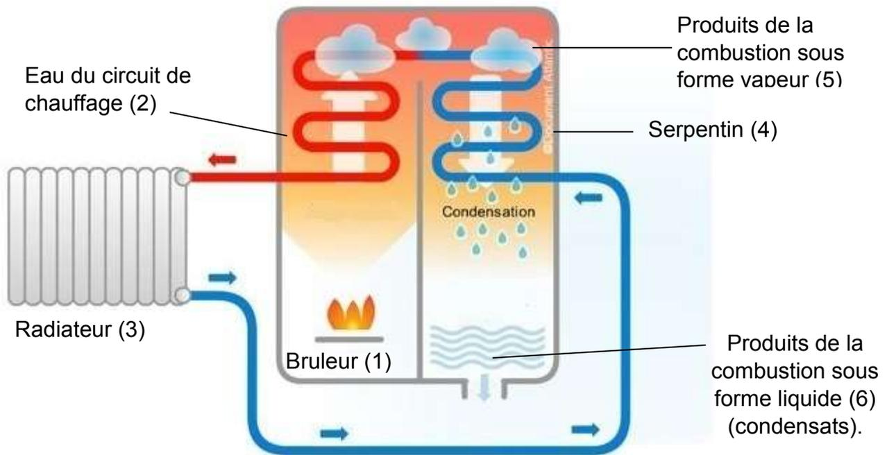
Principe de fonctionnement d'une chaudière à condensation.
