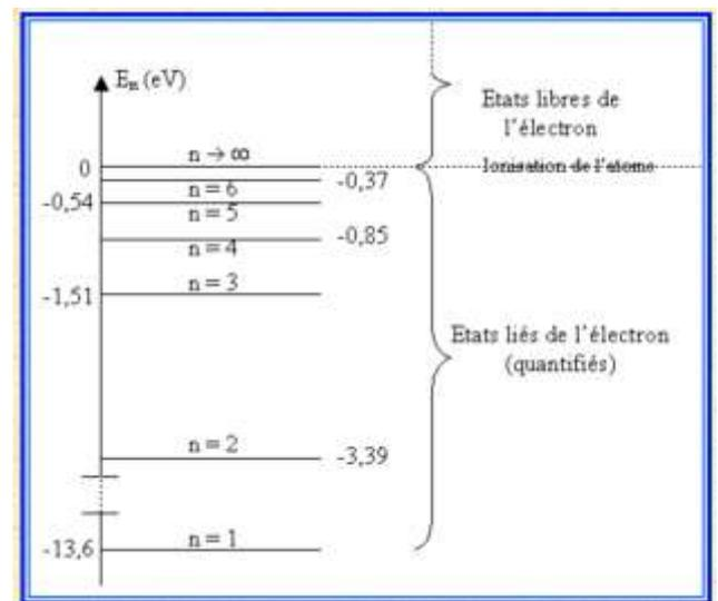
Diagramme de niveaux d'énergie de l'atome d'hydrogène
