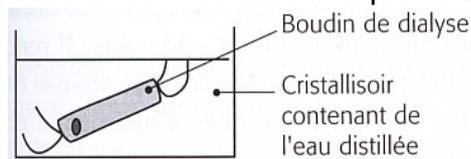
Après 2h d'incubation dans les cristallisoirs, certaines biomolécules sont recherchées dans le contenu des boudins et dans l'eau contenue dans les cristallisoirs. Pour cela, on utilise une solution de lugol de couleur orange et qui se colore en bleu nuit en présence d'amidon et de la liqueur de Fehling à chaud de couleur bleue qui forme un précipité rouge brique en présence d'aldoses (glucose, galactose, maltose, ...).
